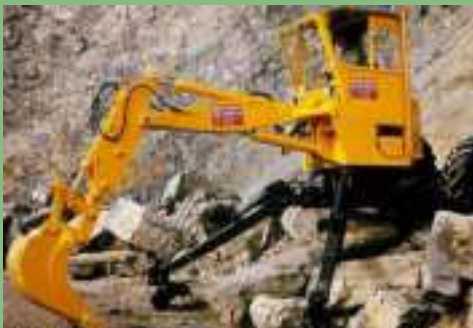
Menzi Muck 3000M Jahrgang: 1970 Gewicht: 3150kg Motor: Hatz, 2 Zylinder Leistung: 40PS
